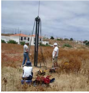
Figura 2 – Exemplos de penetração dinâmica super pesada (DPSH).
