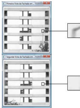
Figura 3: Detecção de pontos característicos não-coplanares com a fachada.
