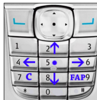
Figura 2. Funções das teclas no sistema NavTap
