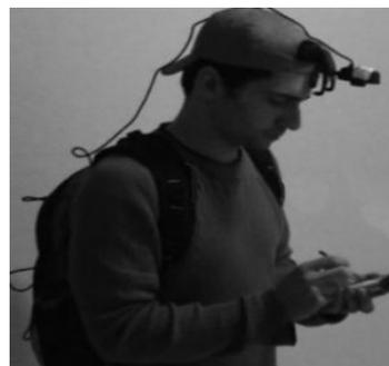
**Figura 11: O kit de video móvel é composto por material comum: uma webcam comum, uma mochila, um computador portátil e um chapéu/boné.**
