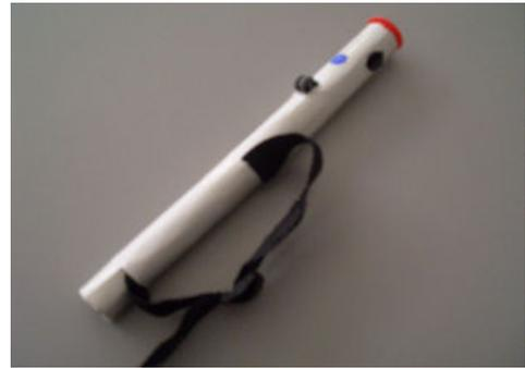
**Figura 8: O protótipo tem um sensor de infra-vermelhos na sua ponta, o que permite detectar a distância de obstáculos. Também está munido de uma ligação sem fios (Bluetooth) com um auricular para o qual emite avisos e mensagens para os utilizadores.**
