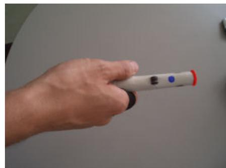
**Figura 9: A roda de interacção (e.g., o mini-joystick) foi construída com a utilização de uma roda de isqueiro, permitindo ao utilizador rodar efectivamente o joystick enquanto queria seleccionar as várias opções que lhe permitem interagir com o protótipo, ao mesmo tempo que conseguia segurar a bengala com facilidade sem utilizar outra mão.**
