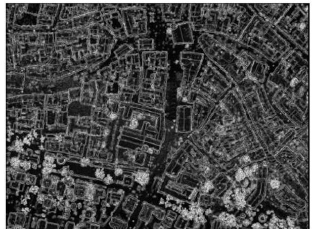
Fig. 3: Segmentação após o cálculo das rugosidades do DSM
