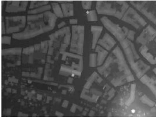
Fig. 1: Exemplo de um DSM representado em tons de cinzento
