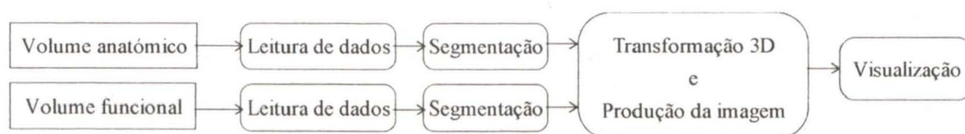
Figura 1: Esquema ilustrativo da estrutura modular utilizada na versão em Explorer. Cada módulo efectua uma das operações do processo de produção da imagem.
