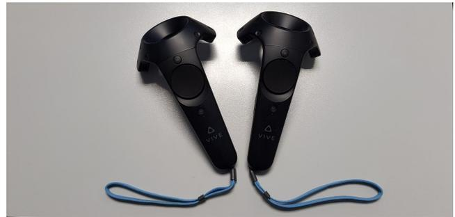
**Figure 1:** Mandos del HTC Vive que pueden ser usados para navegar a través de la base de datos de manera visual mediante varios sensores de entrada como el trackpack multifunción y los disparadores dobles.
