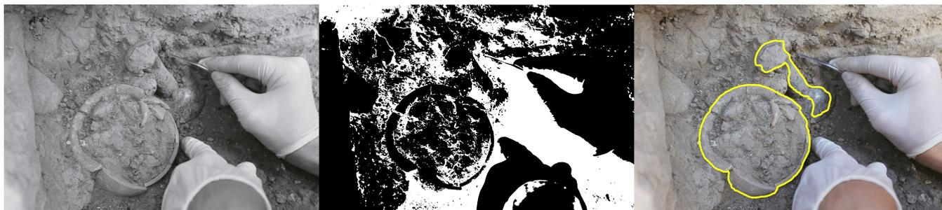
**Figure 6:** *Proceso de segmentación resumido en tres pasos. La primera imagen es la conversión de RGB a escala de grises, la segunda imagen es una mayor definición de las fronteras proporcionada por ARCore, y la última es la extracción del contorno superponiéndolo en la imagen original. Cada imagen es la entrada del siguiente paso (izquierda a derecha).*
