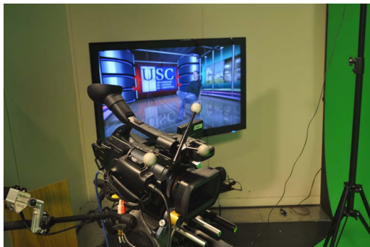
Figure 2: Marcadores pasivos unidos a una cámara
