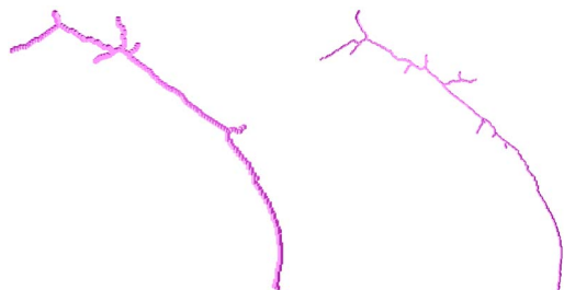
Figura 6: Esqueletos del cuerno de la figura 3 obtenidos por adelgazamiento a resoluciones de 256^3 y 512^3 .
