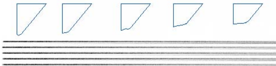
Figura 12: El esquema en azul representa el estado de la mina según se va avanzando en el trazo sobre el papel. Se puede observar como el lápiz va perdiendo presión a medida que la punta se va redondeando.
