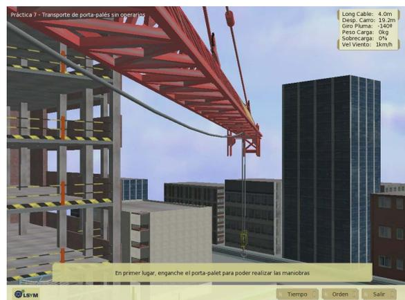
**Figura 8:** Simulación de los cables de elevación. El modelo dinámico empleado permite reproducir la oscilación transversal del cable y la formación de catenaria en los tramos horizontales.
