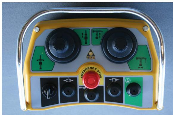
**Figura 9:** Mando de grúa Torre utilizado en el simulador. El mando está sensorizado con una placa de E/S con salida USB y compatible HID.
