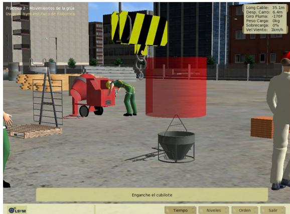
**Figura 6:** Zona de enganche de la carga. Un cilindro de color rojo representa la zona segura del gancho para poder realizar el enganche. Cuando el gancho se encuentra en la zona de enganche, el cilindro cambia a color verde.
