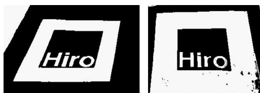
Figura 7: Resultados de la segmentación de un marcador hecho con papel terciopelo (izquierda) y tinta de impresora de inyección (derecha).
