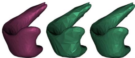
Figure 3: De izda. a dcha.: malla inicial de la forma media de la población (1506 puntos), y mallas simplificadas (754 vértices): con el método de eliminación de vértices y con el método propuesto.
