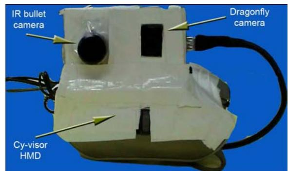
**Figura 6:** Sistema de captura y visualización (cámara DragonFly, Cámara de Infrarrojos y el HMD)
