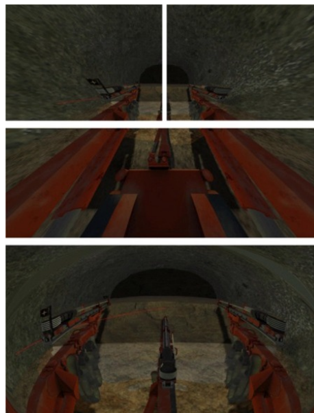
Figura 4: Imágenes generadas mediante proyección perspectiva y la imagen final que se genera mediante proyección esférica
