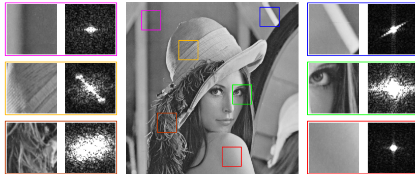
Figure C.3 – La transformée de Fourier d’une signal décrit ses variations. Nous illustrons cette notion à l’aide de l’image de Lena. Nous utilisons une sélection de portions de l’image et affichons les transformées de Fourier locales dans des encadrés. Les régions de faible fréquence sont compactées autour de l’origine de l’espace de Fourier alors que les régions de haute fréquences sont étendus dans cet espace.
