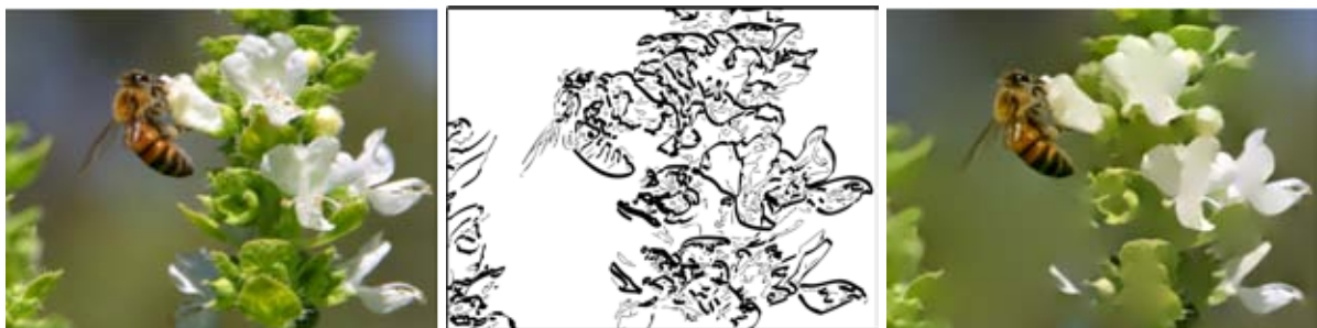
Figure A.6: A partir d'une photographie (gauche), notre approche permet à l'utilisateur de manipuler la structure de l'image pour créer des représentations simplifiées. L'image du milieu est le résultat d'un rendu type dessin au trait où l'épaisseur des lignes est proportionnelle à leur importance. Dans l'image de droite, seuls les détails de l'abeille sont préservés pour attirer l'attention. Image en provenance de www.pdphoto.org .
