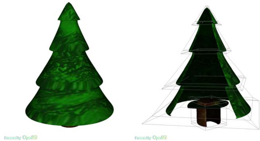
Abbildung 5.24: Effekt der Backface-Culling-Heuristik des adaptiven Verfahrens: Links das originale Bild, rechts die Auswirkung der Backface-Culling-Heuristik demonstriert durch eine zweite, rückseitige Kamera. Modell von Volker Settgast.
